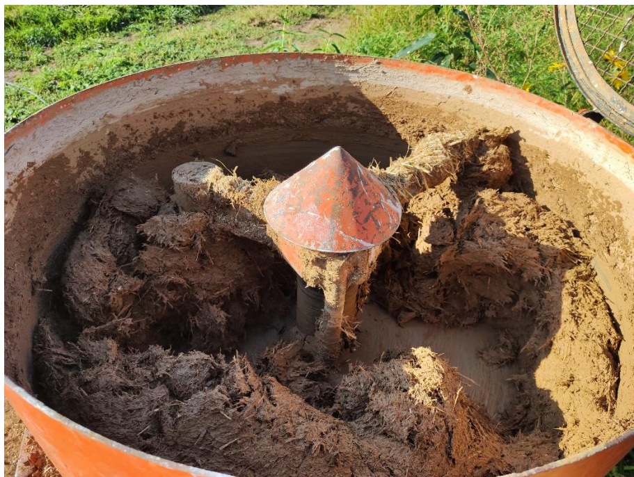
Obr. 2 – Připravená směs před zahájením výroby válků
