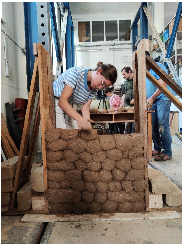
Obr. 5 – experimentální stavba válkového zdiva (viz varianta I.)
